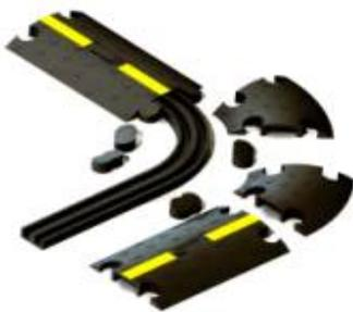
Поддоны кабель-моста (прямые и угловые участки) располагаются на полу. По двум пазам вдоль поддонов прокладывается кабель, сверху надеваются защитные корпуса (прямые и угловые). Вся конструкция жестко скрепляются между собой при помощи
