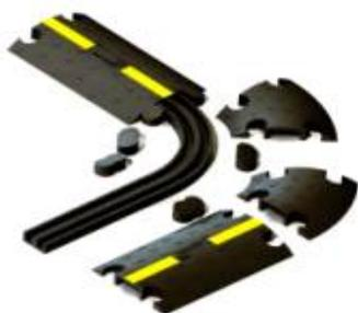
Поддоны кабель-моста (прямые и угловые участки) располагаются на полу. По двум пазам вдоль поддонов прокладывается кабель, сверху надеваются защитные корпуса (прямые и угловые). Вся конструкция жестко скрепляются между собой при помощи
