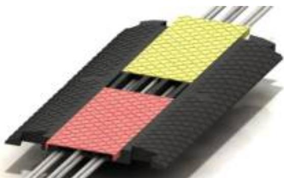
Корпусы кабель-моста располагаются на полу, земле, асфальте и жестко скрепляются между собой при помощи торцевых выступов и пазов. По трем пазам вдоль корпусов прокладываются кабели, сверху надеваются защитные крышки.
